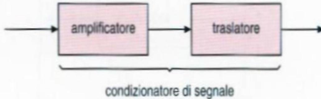
L'amplificatore deve portare l'intervallo da  $(V_{\max \text{ trasd}} - V_{\min \text{ trasd}})$  all'intervallo  $(V_{\max \text{ adc}} - 0)$ .
